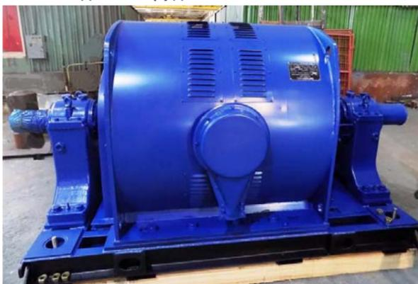
Двигатель предназначен для эксплуатации в составе дробильного агрегата, выполняющего функцию дробление твердых горных пород, и заказан по программе модернизации рудника.
